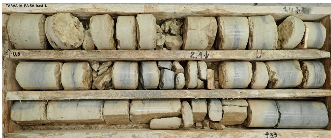
Foto 5.1. Tarva IV uuringuruumi läbilõike ülaosas lasub kollakashall dolokivi. PA-5A, int 0,5 - 3,3 m.
