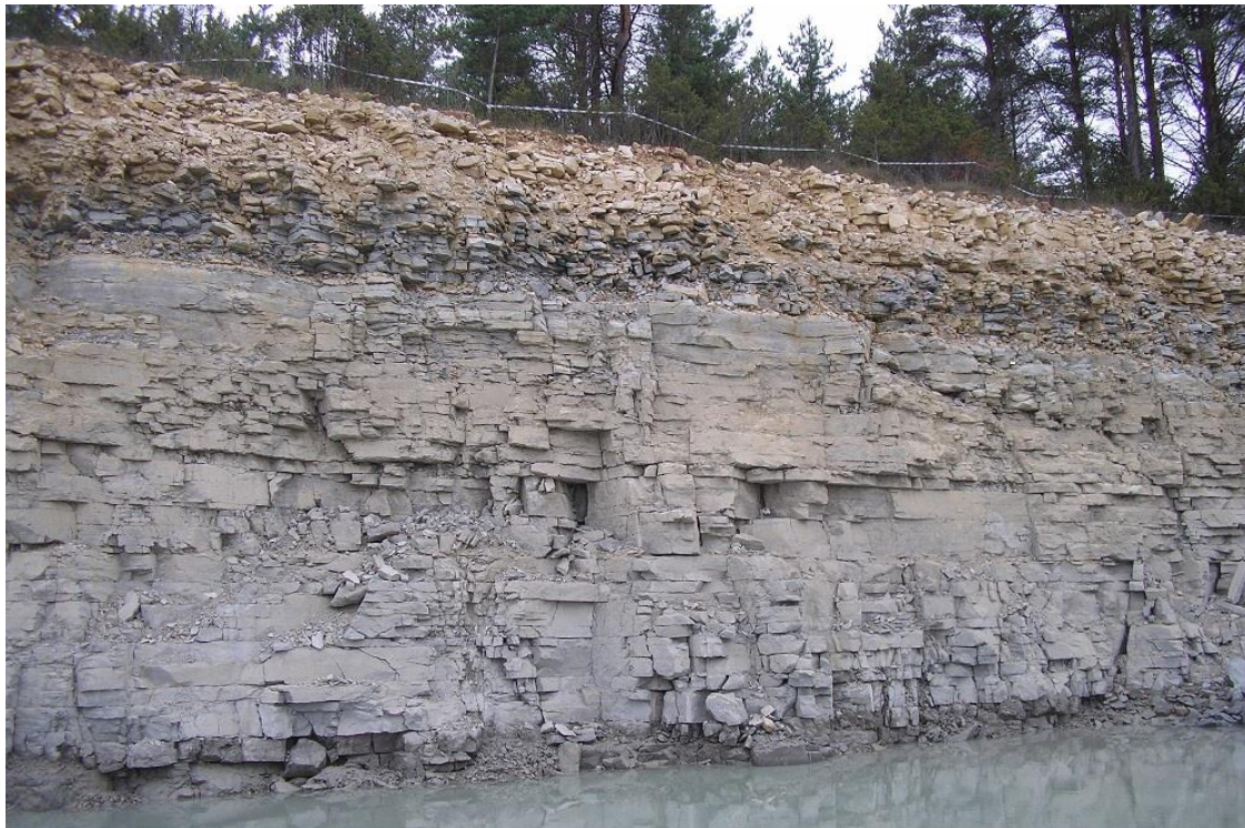
Foto 5.2. Tarva karjääri ~9 m kõrgune läänessein, kus ülaosas paljandub ~1,5 - 2 m paksuselt kollakas murenenud ja porsunud dolokivi ning selle all keskmise-paksukihiline hall dolokivi, moodustades Tarva dolokivimaardla kasuliku kihi (foto T. Tuuling, 05.10.2013, N 58°37'17" ja E 24°00'55").
