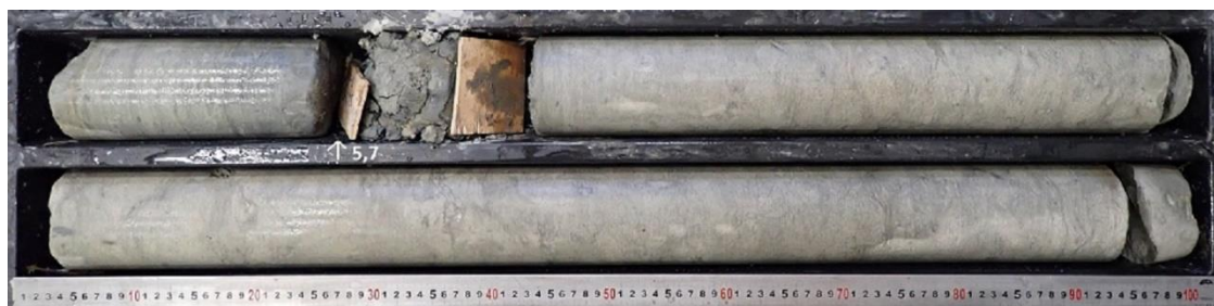
Foto 5.5. Markeerivaks kihiks oleva savise domeriidi vahekiht puuraugus PA-4 sügavusel 5,7 m. PA-4 int 5,5 - 7,5 m.
