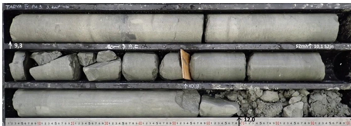
Foto 5.6. Muhu ja Jaani kihistu piir on märgitud püriitstest katkestuspinnast ~0,5 m sügavamal, millest allpool saab valdavaks savine dolokivi ja domeriit. PA-3, int 9,3 - 12,5 m.
